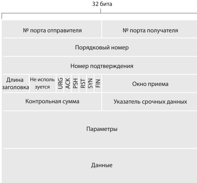
Рис. 3.29. Структура TCP-сегмента
