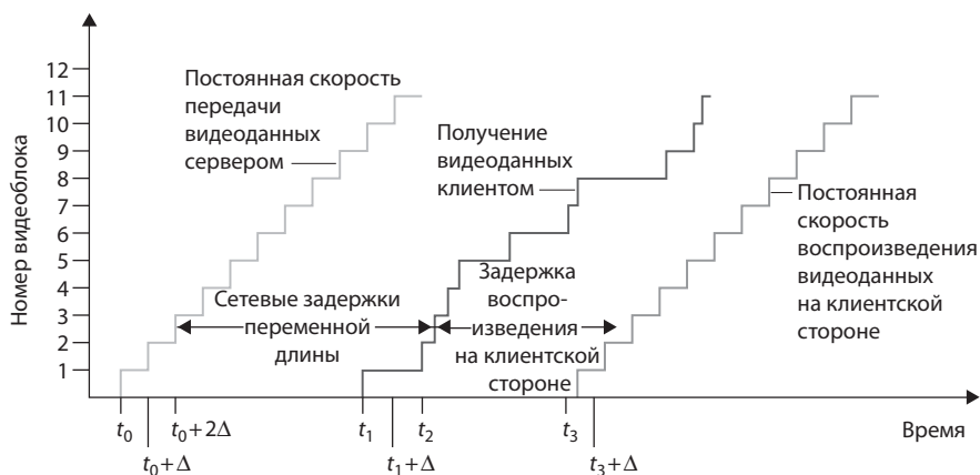
Рис. 7.1. Задержка воспроизведения потокового видео на клиентской стороне
