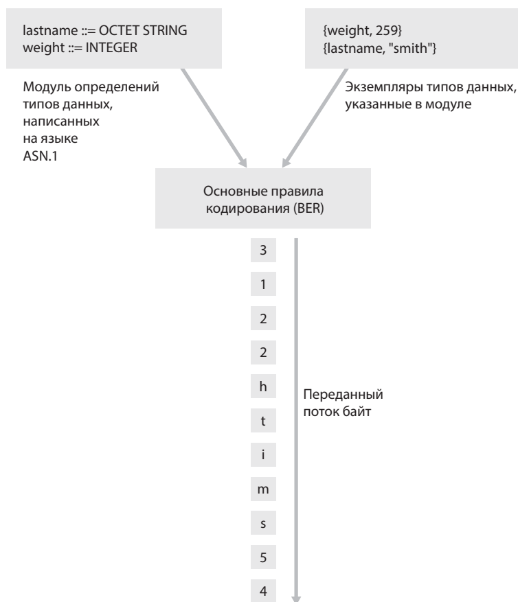
Рис. 9.9. Пример кодирования в системе BER
