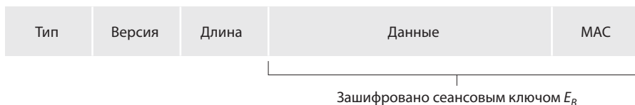
Рис. 8.26. Формат записи для SSL
