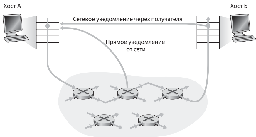
Рис. 3.49. Два возможных уведомления от сети о наличии перегрузки
