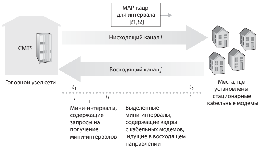
Рис. 5.14. Восходящие и нисходящие каналы между головной узловой станцией и кабельными модемами
