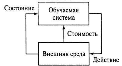
Рис. 12.1. Блочная диаграмма взаимодействия обучаемой системы со средой
