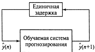
Рис. 14.24. Система одношагового прогнозирования, используемая при итеративном прогнозировании для динамического восстановления хаотических процессов
